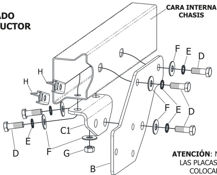
**ATENCIÓN:** NO AJUSTAR TOTALMENTE LAS PLACAS "B", "C1" Y "C2" HASTA COLOCAR EL TRAVESAÑO "A"
